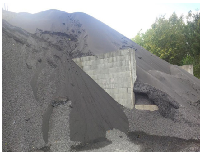
FIGURA 5. ACOPIO DE FRACCIONES DIFERENCIADAS DE ÁRIDO SIDERÚRGICO SOBRE CAPA IMPERMEABLE
