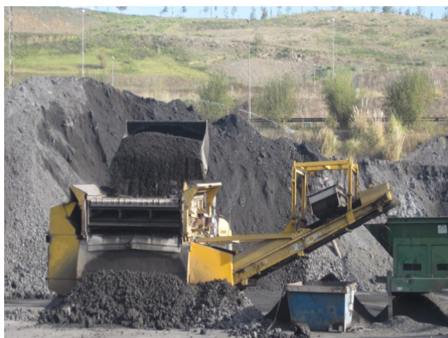
FIGURA 4. SISTEMAS DE CRIBAS DE MATERIAL GRANULAR PROCEDENTE DEL TRATAMIENTO DE ESCORIA
