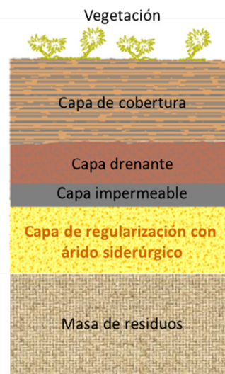
FIGURA 17: CAPAS DE CUBRICIÓN DE VERTEDEROS.
